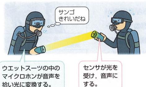
る。可視光を受信したダイバーは、受信機で受けた光を音声にし、骨伝導スピーカにより声を認識することができる。
