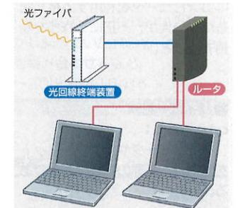
※ルータを使わずに、1台のパソコンが光回線終端装置と接続される形態もある。
